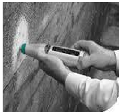
Fig – 4.2.1A) Rebound hammer
